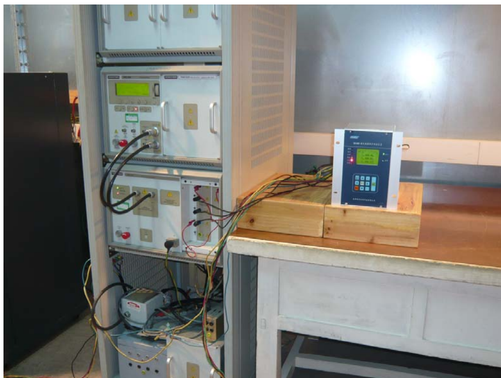
图 5: 浪涌抗扰度检验配置图
