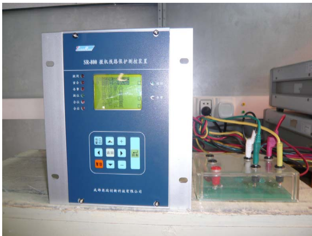
图 7: 工频抗扰度检验配置图
