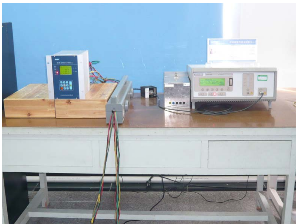
图 6: 射频场感应的传导骚扰抗扰度检验配置图
