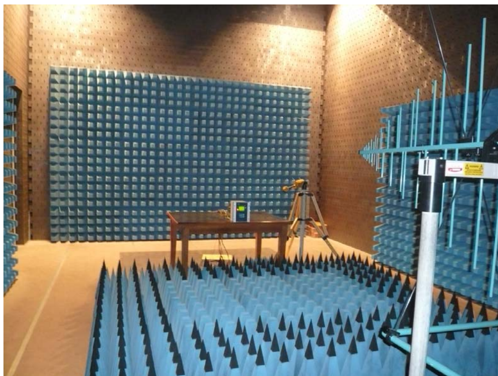
图 3: 射频电磁场辐射抗扰度检验配置图
