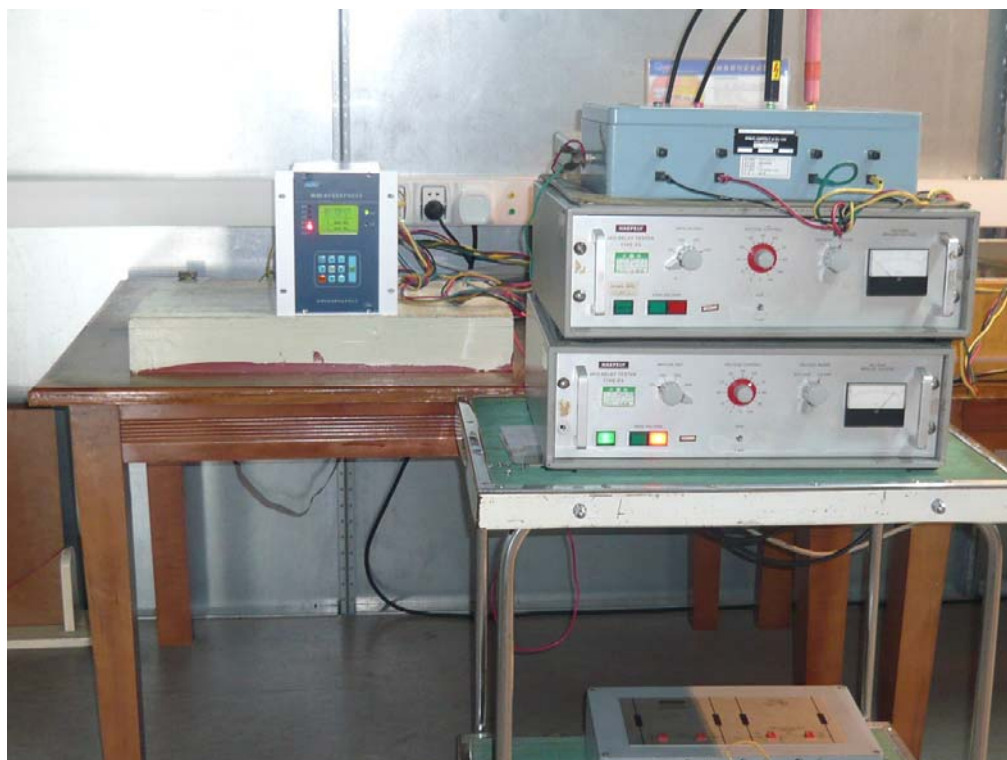
图 1: 振荡波抗扰度检验配置图
