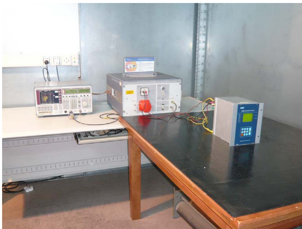
图 8: 传导发射限值检验配置图
